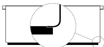
Fondo di spessore 10 mm in acciaio duplex nei modelli multifunzione
